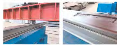
图4 边柱强度动载疲劳试验现场照片 图5 边柱强度动载疲劳试验边柱破坏照片 根据试验结果, 绘制力-位移曲线如下图6所示。
